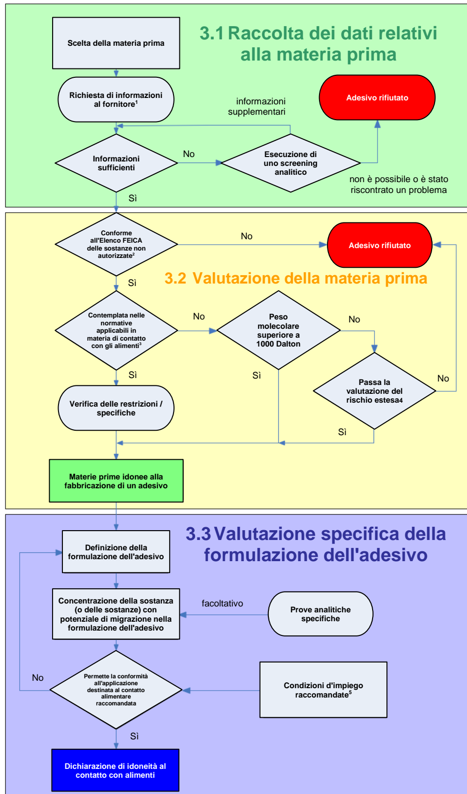
Figura 1. Diagramma di flusso per la valutazione delle materie prime e delle formulazioni di adesivi. (1. vedere l'Allegato I per un modello di richiesta di informazioni; 2. vedere l'Allegato II; 3. vedere le Sezioni 2 e 3.2; 4. vedere le spiegazioni di cui alla Sezione 3.2; 5. vedere le spiegazioni di cui alla Sezione 3.3)
